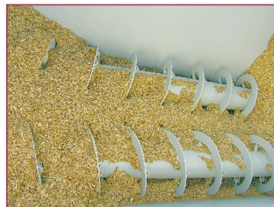
Innenansicht eines Hackschnitzelcontainers mit Förderschnecken
